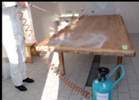
55. Fase di detersione con pompa a bassa pressione
